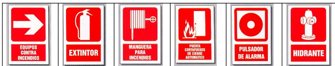
Figura 14: Sinais de instalacións de protección contra incendios
